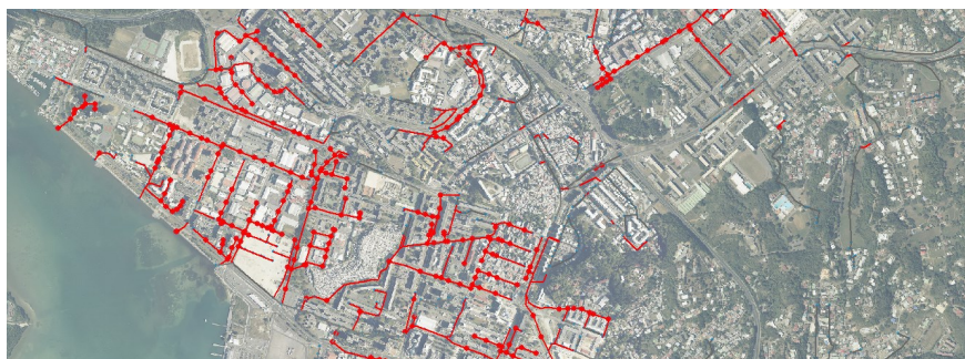
Résultat indiquant en point rouge les débordements et en trait rouge les capacités insuffisantes du réseau pour une pluie fréquente (période de retour 10 ans) ©DHI
